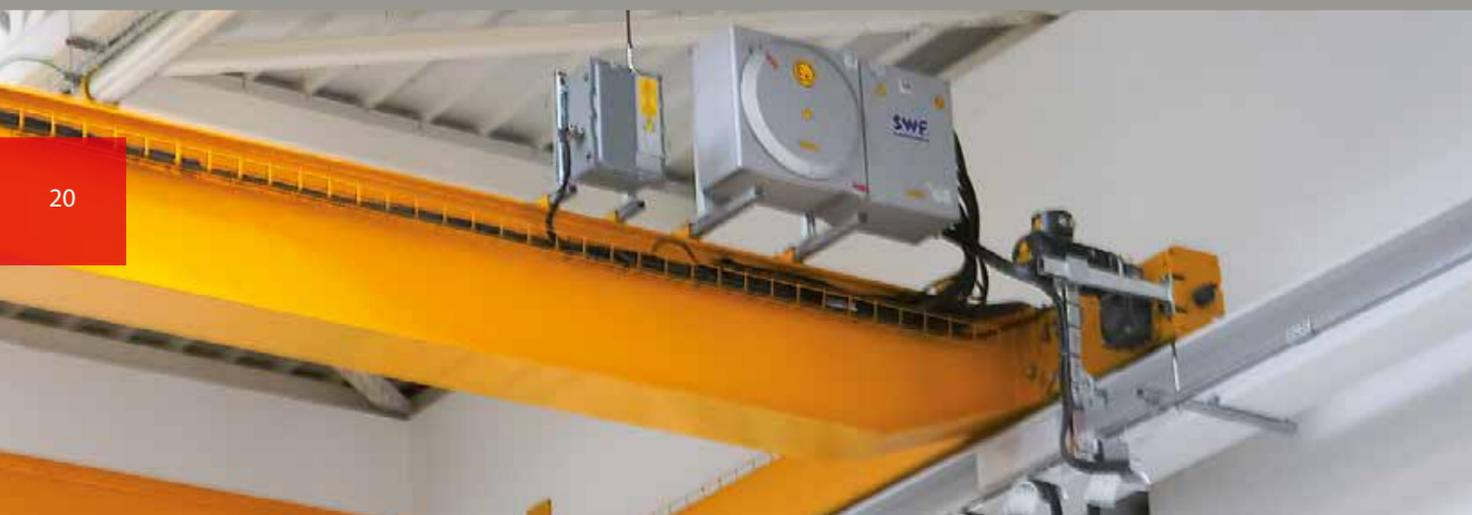
Per MEC GRU ed SWF KRANTECHNIK è standard quello che per altri è speciale oppure non fornibile. Abbiamo lunga esperienza e provata conoscenza nella fornitura di impianti di sollevamento antideflagranti, in particolar modo gru a ponte manuali ed elettriche che, come quelle per aree sicure, sono assemblate con componenti e paranchi SWF
